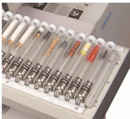
試料は、左の画像のように空の試料管に直接入れた後、加熱して発生ガスを濃縮し、GC/MSで導入しました。
