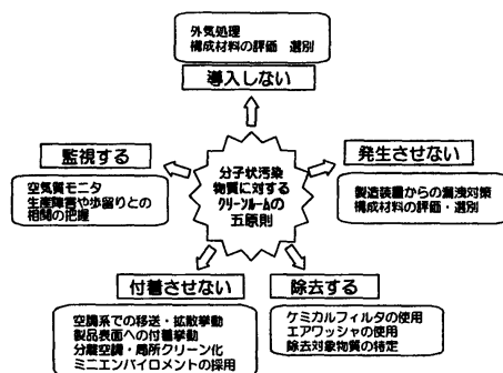
図1 分子汚染を防止するためのクリーンルーム五原則
