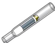
外径6mm 長さ 36mmの石英ガラスのチューブにテナックスGRを詰め、その周りにF280のパイロホイルを巻きつけた吸着管のこと。
